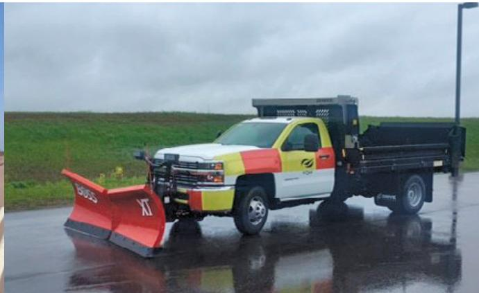
Le nouveau camion 4X4 d'une tonne muni d'une benne basculante et d'une charrue en « V » facilitera les activités à la fois en été et en hiver.
